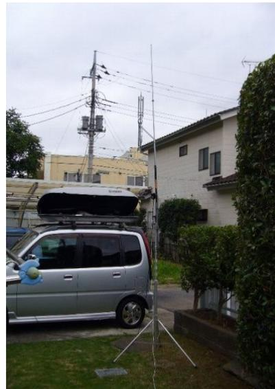
写真③ 庭先で運用。三脚+ポールで3m高。移動運用にも使っています。
