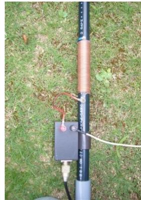
写真② RFCの内部。W1JR巻きヤザキのイレクターでパイプに固定
