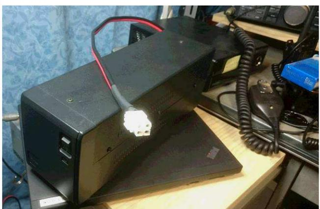
オークションで手に入れた電源。コネクタが破損、電圧も怪しいのでばらして確認。200V での設定になっていたなので、100V への変更とコネクタを付けました。
