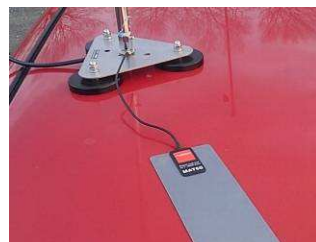
写真6 大型のマグネット基台を使用し MAT50 でグラウンドを確保
