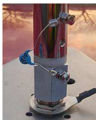
写真5 コンデンサはコネクタのネジ穴に取り付け
