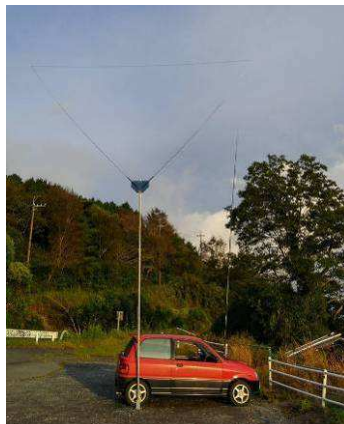
21MHzのデルタループと垂直に立てたツェップ。全市全郡コンテストにて
