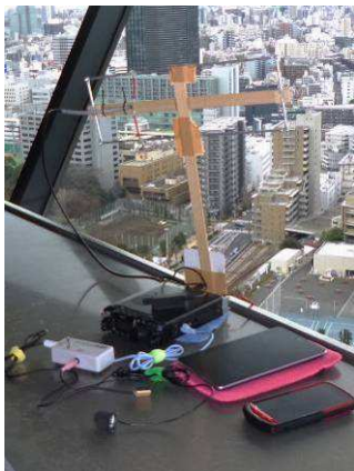
展望台移動に使うために作った430MHz用ヘンテナ。関東UHFコンテストにて
