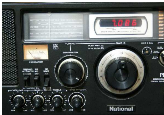
7MHz SSBを受信中。下の四つのつまみの一番右がBFO。LSB側に絞って受信する
