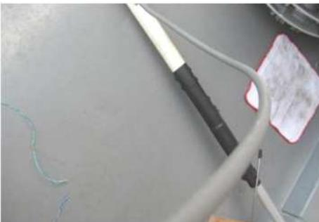
最近流行りの FT8 をやりたくなり、調整（先端のエレメント長を変える）しようとマストから外しました（アンテナに直ぐアクセス出来るのがアパマンハムの魅力・・・などと思いながら気軽に作業を開始）。設置してから 7 年間、何もしていなかったのが災いとなったのでしょうか！エレメントが固着して全くスライドしません。（\*\_\*; プライヤーで掴んでもダメ、ハンマーで叩いてもダメ。
