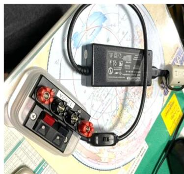
ケーブルを先バラにして端子につなぐだけで完成。ネジターミナルの方が 12V2A。プッシュ式の方が 5V2A 取れるので USB のメス端子をつけると電源ボックス (充電器) 的に使えます。
