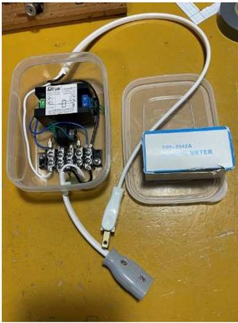
100円均一の食品ケースに入れ完成は下の写真の様になりました。常時電圧と電流を監視することもないので、使う時だけ電源コンセントの途中に挿入できるようにしました。
