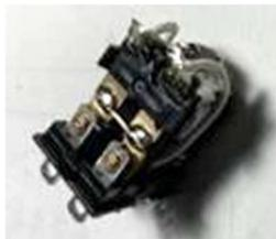
入れて、必要な端子(駆動コイルと接点)だけをメッキ線で延長し元の基板に取り付けるだけ。工作としては簡単ですが、ビールと一緒に作業な
